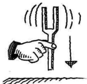
Опять ударь камертон о колено. Теперь поднеси его к столу и поставь основанием на поверхность. Как он звучит теперь? Изменилось ли что-нибудь? Потренируйся на разных предметах (классная доска, подоконник, шахматная доска и так далее). Какие свойства поверхности помогают усилить звук? Какие свойства только приглушают звук камертона?
