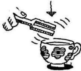
Многие увлажнители воздуха в жилых помещениях основаны на таком же принципе. Вода из специального резервуара попадает в испарительную камеру. Нижняя часть камеры колеблется с очень высокой частотой, которую человеческое ухо не может зафиксировать (поэтому такая частота называется ультразвуковой). Энергия колебаний передается воде, и частицы воды получают достаточно энергии, чтобы вылететь из камеры в окружающий воздух.
